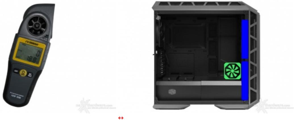
Abbiamo dunque testato la portata posizionando un anemometro Omega HHF-308 a circa un centimetro da una delle due ventole anteriori, misurando la velocità del flusso, calcolata inizialmente in m/s (metri al secondo) con e senza pannello anteriore e, successivamente, trasformando il tutto nell'unità di misura generalmente usata per le ventole, ovvero i CFM (metri cubi al minuto) considerando che, data la forma, il flusso è di tipo circolare con raggio di 10cm.
