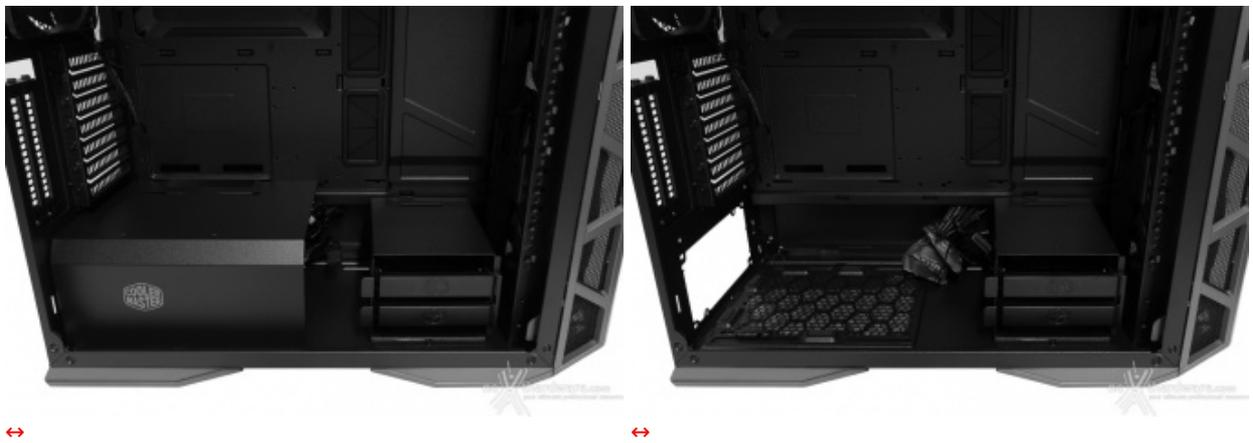
Sotto di essi andrà installato l'alimentatore con una lunghezza massima di 200mm e, se necessario, potranno essere posizionati altri due drive da 3,5" su di un supporto che può anche essere spostato centralmente o nella zona superiore.
