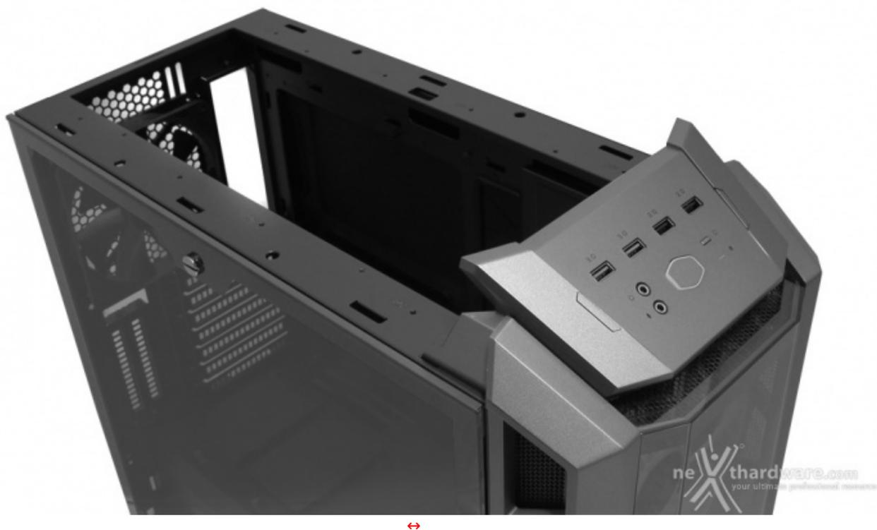
In questo modo si accede ad una struttura removibile, fermata a quella principale tramite quattro viti, che consente l'installazione di tre ventole da 120 o 140mm.
