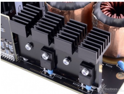
Particolare del dissipatore dedicato ai componenti del sistema di controllo del fattore di potenza (APFC).
