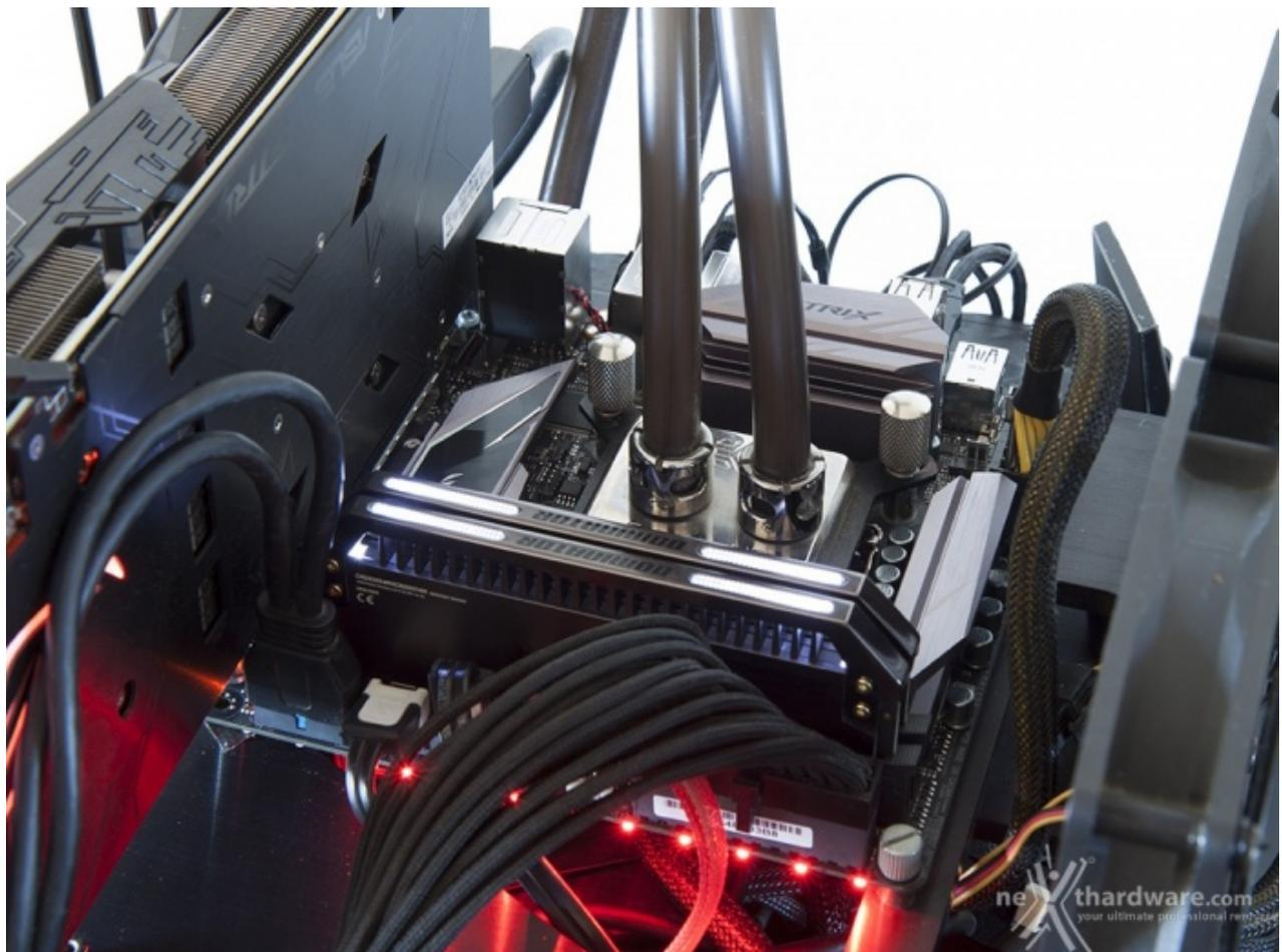
Per quanto concerne il comparto memorie la mainboard è riuscita a spingere il nostro kit di Dominator Platinum SE Blackout alla ragguardevole frequenza di 4133MHz con timings impostati a 15-15-15-35 2T ad una tensione di 1,53V.
