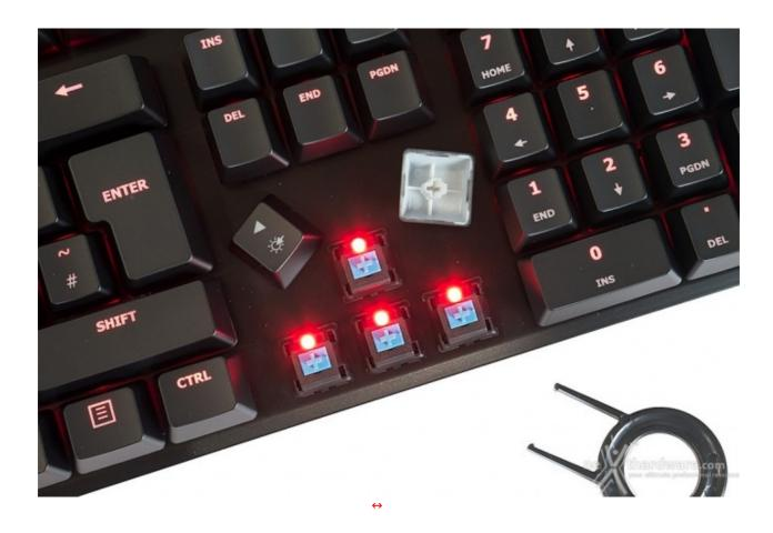
Sotto i tasti, costruiti con la solita tecnica dell'incisione laser, che lascia alla plastica trasparente il compito di illuminare le legende, scopriamo come HyperX faccia uso della serie originale degli switch MX, nello specifico quelli predisposti per l'uso di LED *through-hole* incastonati nel corpo.
