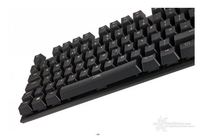
Il secondo punto fondamentale è il design a switch esposti, una scelta progettuale che consiste nell'utilizzare il plate di montaggio degli switch (presente in ogni tastiera meccanica per requisiti di rigidità ) come parte superiore dello chassis in opposizione a quelle soluzioni che utilizzano una scocca in plastica aggiuntiva come top.
