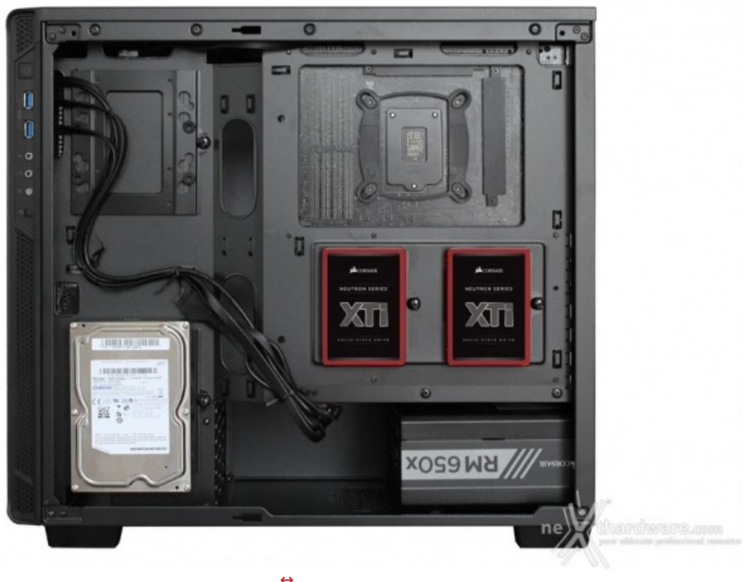
Abbiamo successivamente installato, tramite l'ausilio di un cacciavite, sia l'Hard Disk da 3,5" che i due SSD da 2,5".
