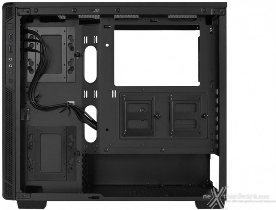
Per accedere al resto delle predisposizioni per i componenti hardware è necessario rimuovere la paratia destra; fatto ciò possiamo notare come due drive da 2,5" potranno essere montati centralmente sul retro del supporto per la scheda madre, mentre altre due unità da 3,5" o 2,5" potranno essere fermate, su appositi supporti, lateralmente a ridosso del frontale.
