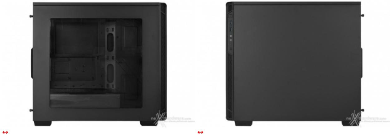
Le paratie laterali sono realizzate in robusto acciaio e non presentano dettagli degni di nota; quella di sinistra è contraddistinta da una finestra in plexiglas sagomata ad hoc per far scorgere, dall'esterno, la scheda madre ed i componenti ad essa direttamente connessi, nonché la cover per l'alimentatore, anche se quest'ultima non è provvista di loghi o giochi di luce.
