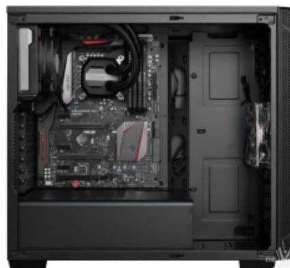
Per prima cosa abbiamo installato la scheda madre in formato ATX abbinata al sistema di raffreddamento All-in-One con radiatore da 120mm montato sul retro del case.
