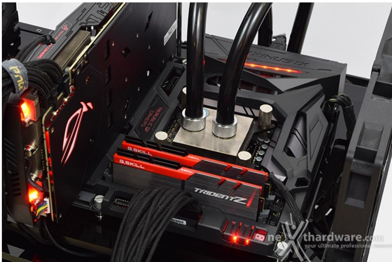
Il nostro sistema di raffreddamento a liquido composto da un waterblock EK Supremacy EVO, un radiatore triventola ed una pompa XSPC X20, si è comportato in maniera egregia riuscendo a tenere a bada il processore in prova anche in condizioni di overvolt piuttosto pesante, grazie anche alle temperature rigide di questi ultimi giorni.
