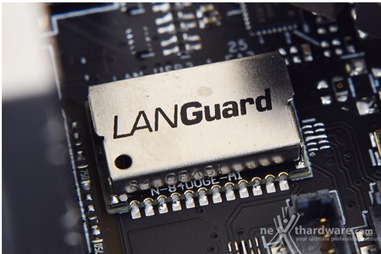
Infine, abbiamo la funzione LANGuard, ovvero un particolare connettore di rete progettato per offrire una protezione fino 1,9 volte superiore rispetto alla norma nei confronti degli effetti dell'elettricità statica e fino a 15kV contro fulmini e sovratensioni che possono propagarsi sulla rete.
