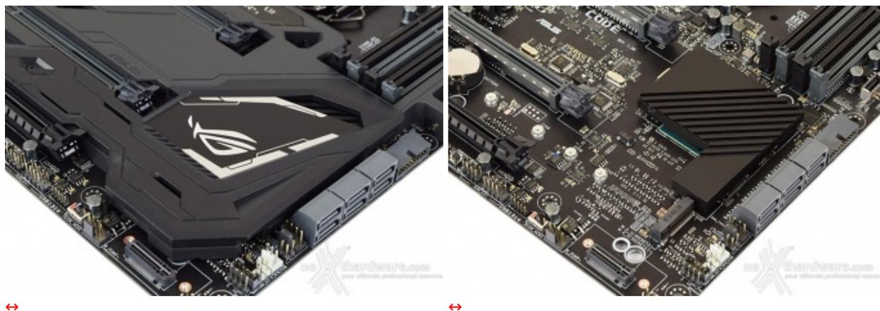
Sottostante l'inserto in stile ROG, questa volta sprovvisto di illuminazione, troviamo un secondo dissipatore, di dimensioni più contenute, preposto al raffreddamento del PCH Z270.
