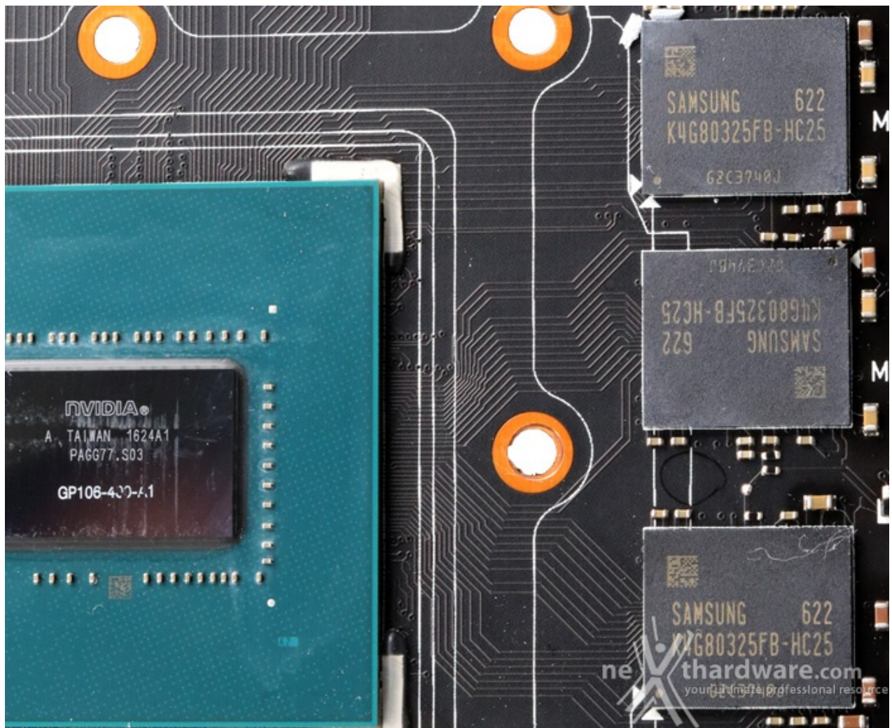
Ecco un particolare di uno dei sei chip di GDDR5 montati sulla ASUS ROG STRIX GTX 1060 OC: dei moduli Samsung K4G80325FB-HC25 accreditati di una velocità di 8GHz con tensione di alimentazione sino a 1,5V.
