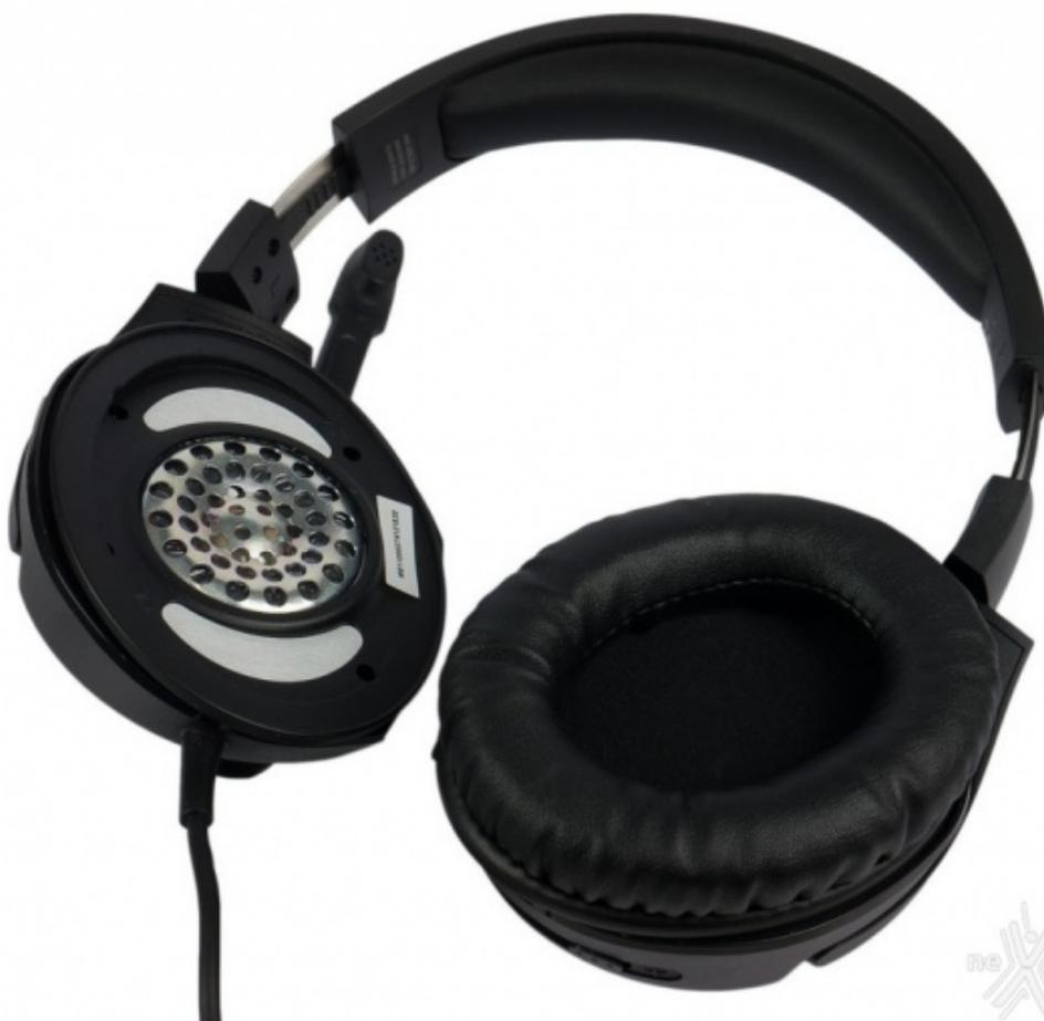
Partiamo con il disassemblare i padiglioni, ovali e rifiniti in pelle, con dimensioni interne misurate in 45x70mm: le operazioni di rimozione e successiva installazione risultano discretamente facili grazie anche ad una buona realizzazione degli stessi.
