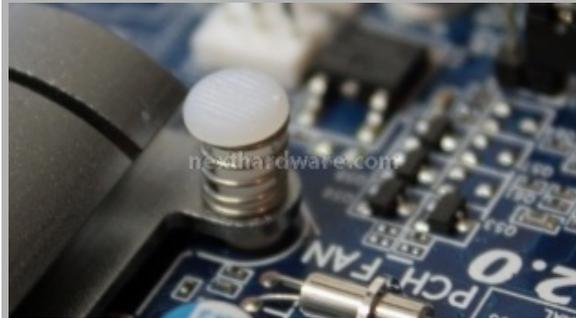
Particolare del sistema di fissaggio del dissy tramite "push - pin".
