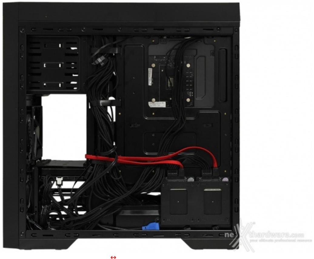
L'organizzazione del cablaggio è stata molto semplice: certamente una cover sulla zona alimentatore avrebbe permesso di nascondere meglio i cavi ma, con circa 20mm sul retro del piatto mainboard, chiunque può essere in grado di creare un sistema pulito e ordinato, soprattutto senza l'ausilio di prolunghe che, in questo caso, non si sono rese necessarie.
