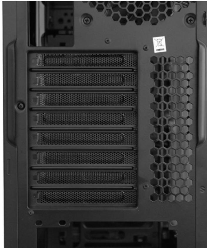
Poco più sotto, otto coprislot PCI permetteranno non solo l'uso contemporaneo di quattro schede video, ma anche di garantire uno scambio termico adeguato grazie alla loro struttura in mesh.
