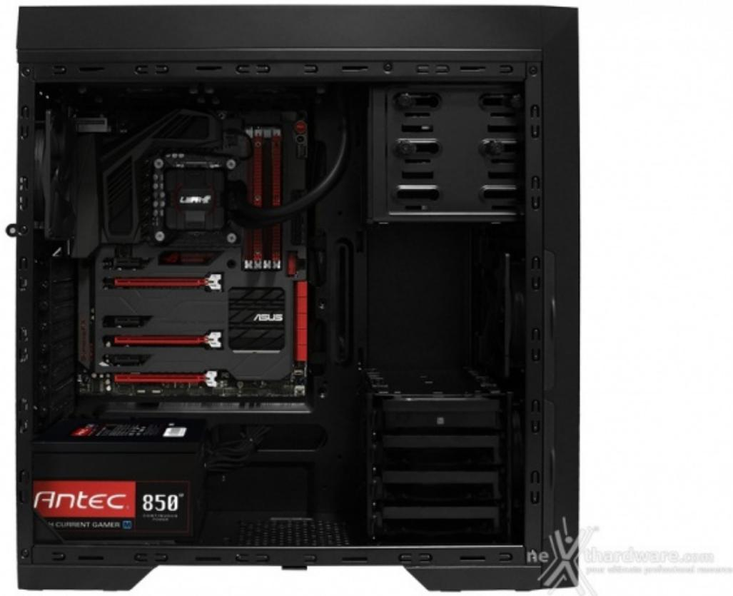
Abbiamo successivamente posizionato l'alimentatore che, essendo di dimensioni standard, avrebbe permesso anche l'installazione di una ventola opzionale da 120mm sul fondo del case.
