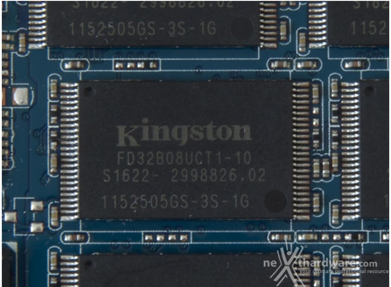
Gli ICs presenti, visibili nell'immagine in alto, siglati **Kingston FD32B08UCT1**, sono in realtà delle Toggle NAND Flash TLC a 15nm di produzione Toshiba, con una capacità pari a 32GB ognuno per un totale di 512GB complessivi.
