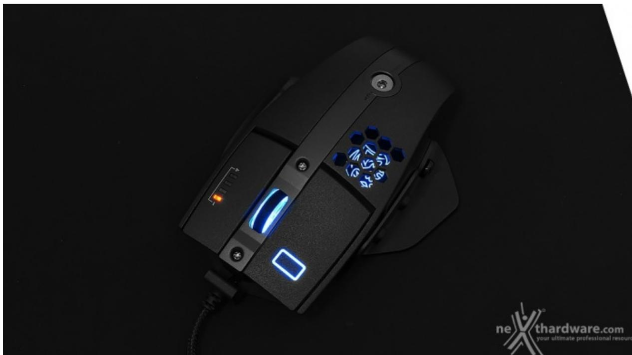
Senza alcun dubbio gradita sui pulsanti principali l'introduzione di due switch meccanici OMRON di ultima generazione D2FC-F-K, garantiti fino a 50 milioni di attuazioni, che si comportano egregiamente in ogni situazione risultando robusti e precisi.
