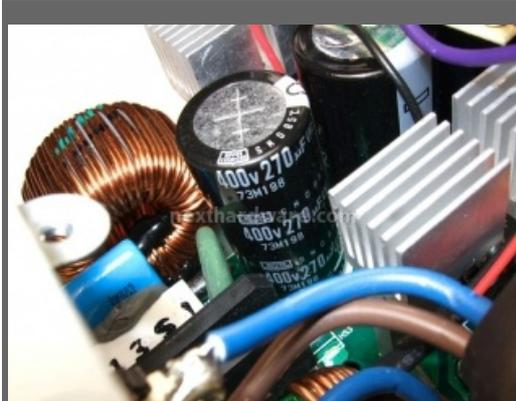
Per la prima volta nelle nostre recensioni troviamo un terzetto di condensatori in ingresso.
