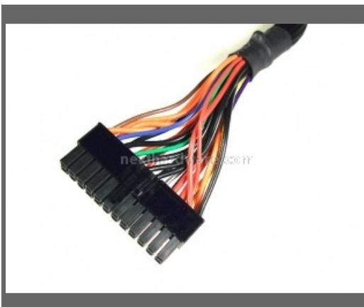
Cavo di alimentazione ATX 24pin
