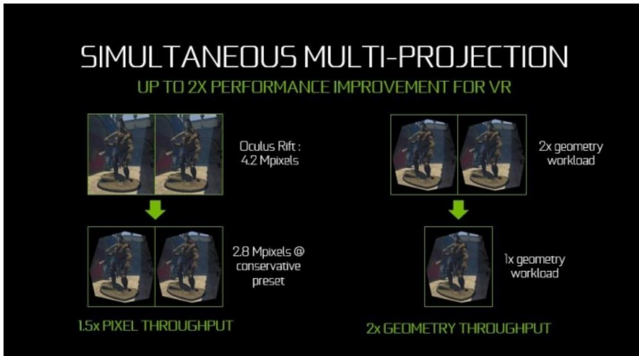
Considerando l'utilizzo contemporaneo delle funzionalità Single Pass Stereo, che permette di processare la geometria dell'immagine una sola volta, e Lens Matched Shading, che riduce il numero di pixel da processare, NVIDIA afferma che le prestazioni in VR vengono migliorate di un fattore 2X sulle nuove schede Pascal con SMP Engine.
