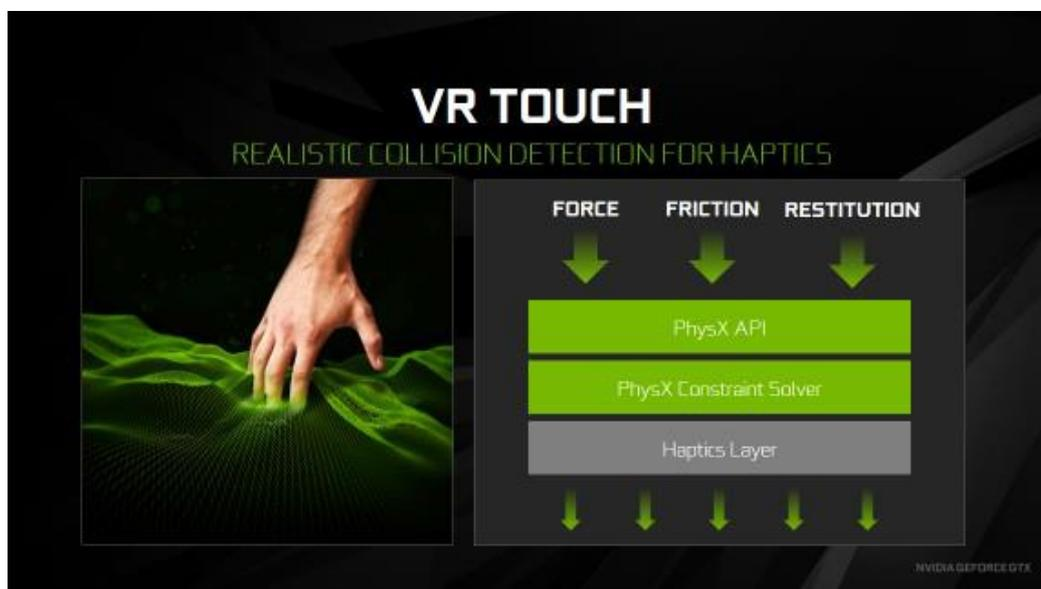
Per questi scopi PhysX for VR utilizza le API PhysX e l'algoritmo Constraint Solver per modellare la fisica dell'ambiente virtuale il più realisticamente possibile e per determinare quando i controller interagiscono con l'ambiente in modo tale da consentire al motore grafico di fornire una risposta aptica fisicamente e visivamente accurata.
