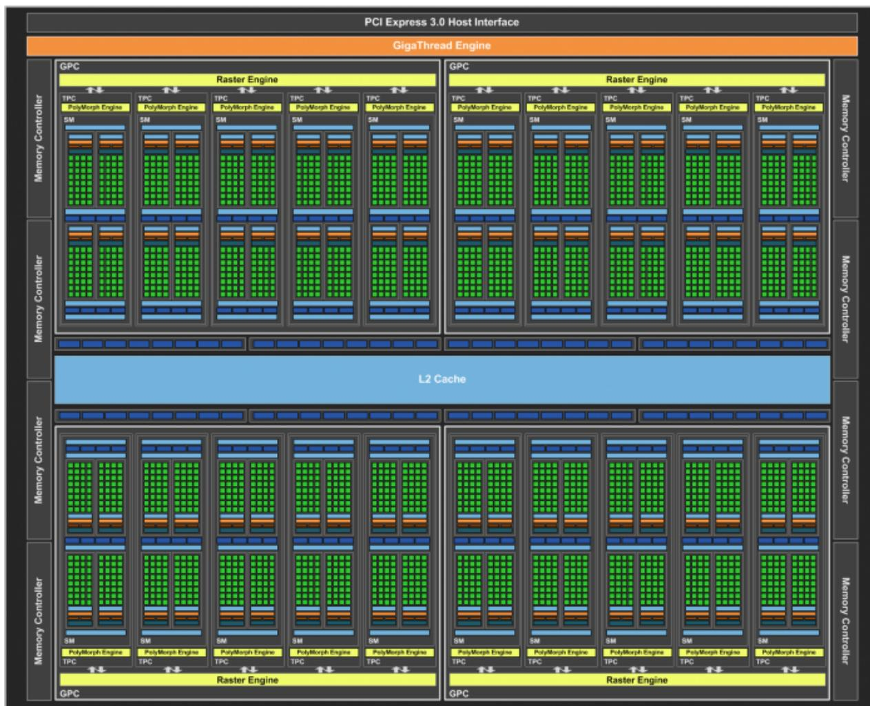
Come per Maxwell, gli SM di Pascal sono dotati di un buffer condiviso da 96kB, che permette di ridurre ulteriormente l'accesso alla cache L2 integrata o alla memoria esterna alla GPU, una cache L1 da 48kB e 256kB di spazio di archiviazione per i file di registro.
