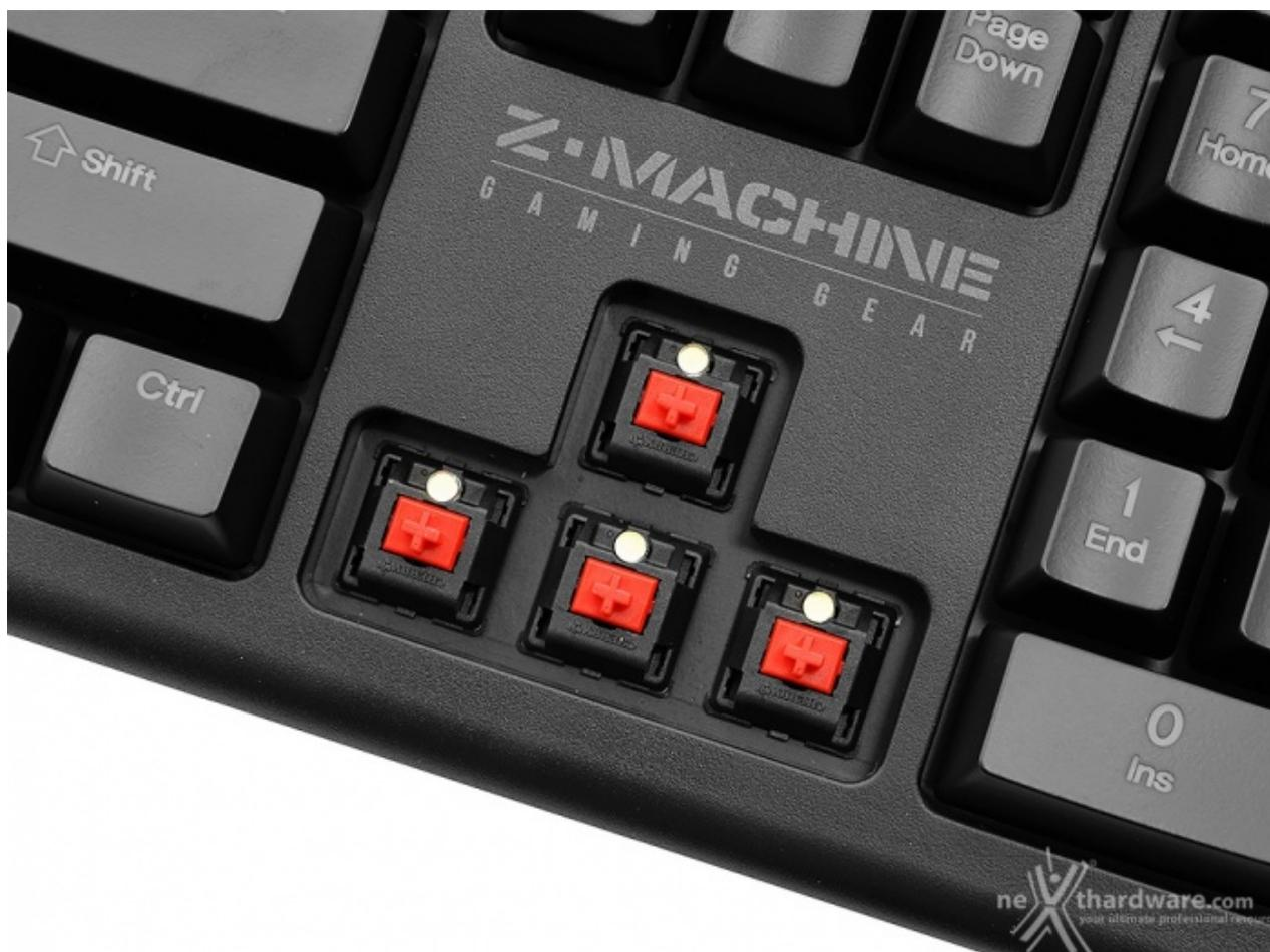
Una volta rimossi i keycaps si potrà accedere direttamente agli switch meccanici Cherry MX Red di cui è dotata la Zalman ZM-K700M giunta in redazione.
