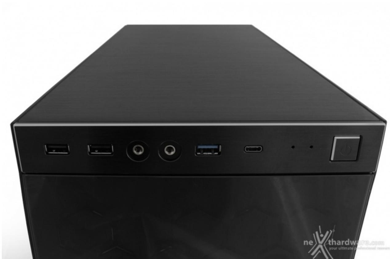
Ubicata nella parte alta, su di un supporto in alluminio anodizzato, sono disposte tutte le connessioni necessarie per interfacciarsi con periferiche di vecchia e nuova generazione, nello specifico due USB 2.0, due connessioni HD Audio, una USB 3.0 standard ed una nuovissima connessione USB 3.1 di tipo C.
