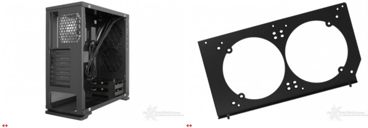
La parte frontale è quasi interamente occupata da un ampio supporto per due ventole da 120 o 140mm removibile.
