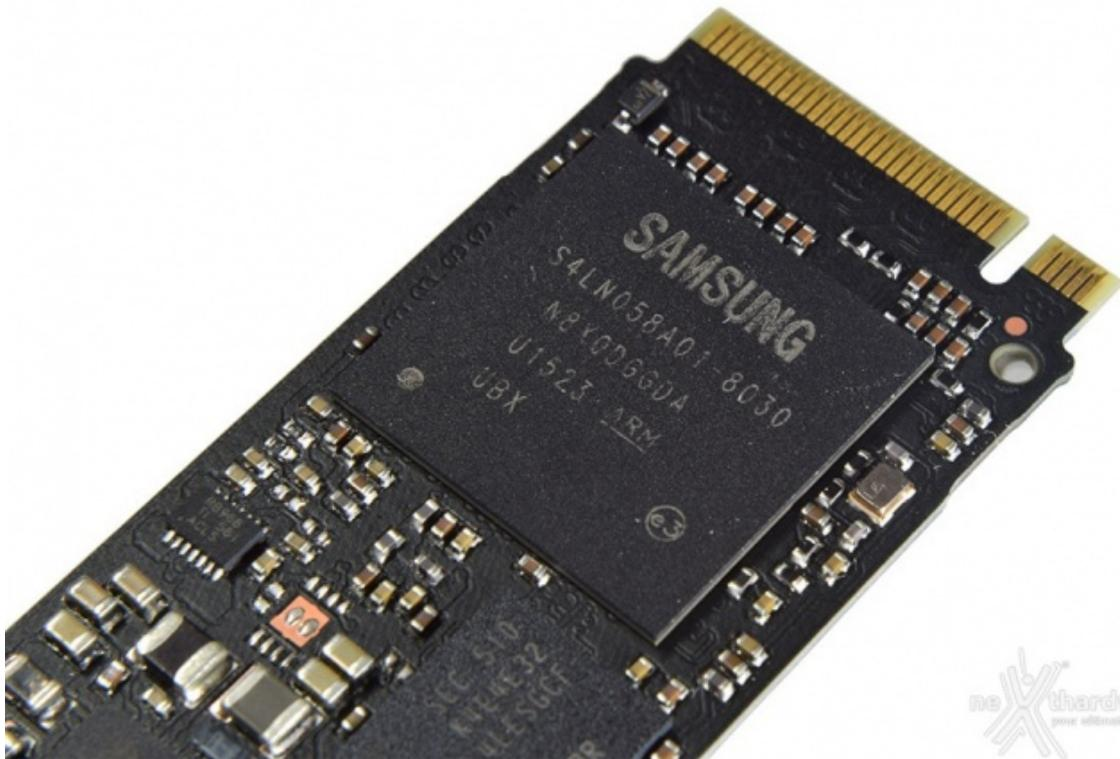
Il controller impiegato per il Samsung 950 PRO è un **UBX S4LN058A01-8030** già utilizzato in precedenza sul modello SM951, dove ha dato evidente prova delle sue potenziali prestazioni.
