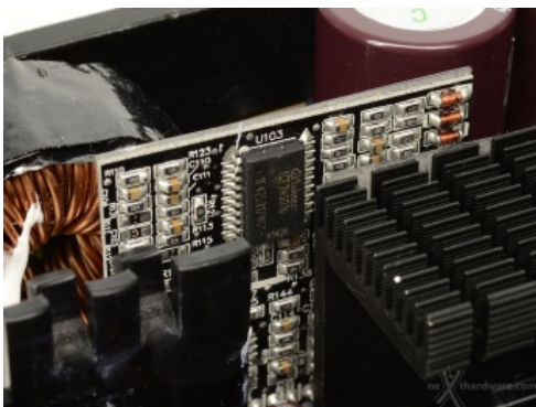
Particolare del controller APFC.
