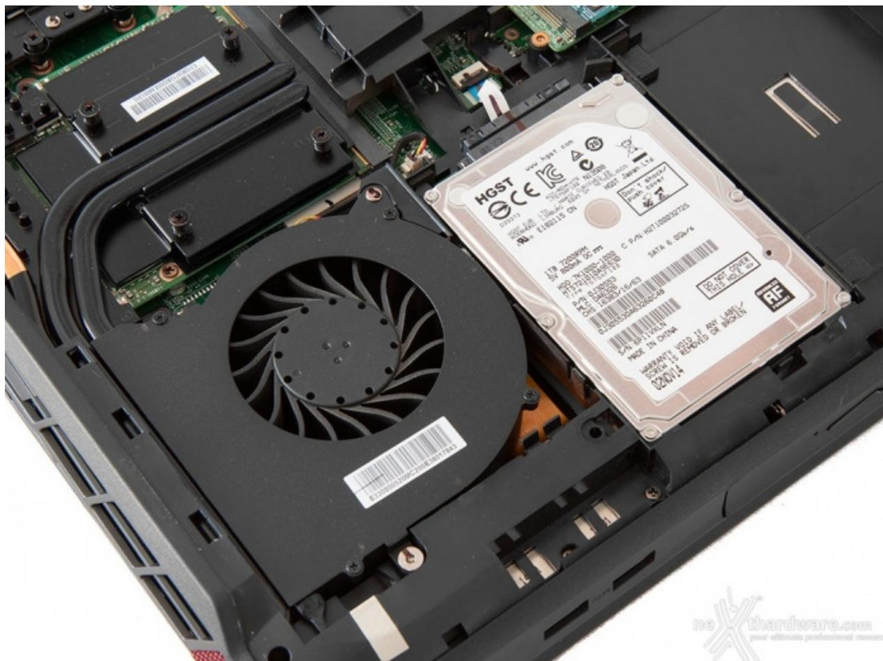
L'immagine in alto ci mostra da vicino una delle due ventole radiali deputate allo smaltimento del calore con alla sua destra il disco meccanico di produzione HGST da 1TB dotato di interfaccia SATA III e di form factor da 2,5".
