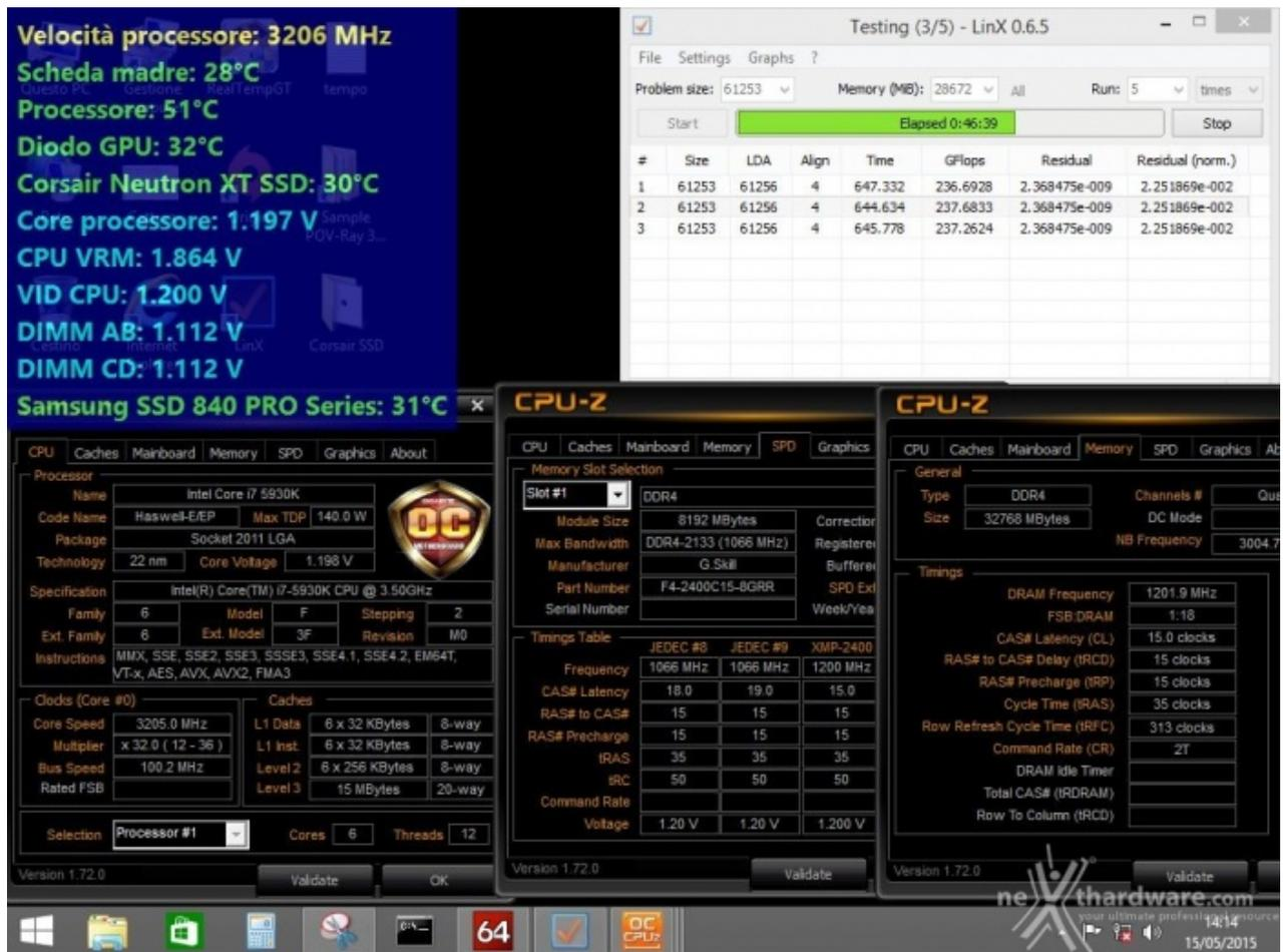
Avendo fallito la seconda parte del nostro test abbiamo quanto meno voluto verificare se il kit di memorie fosse stato in grado di reggere i dati di targa con un valore di tensione inferiore a quello nominale.
