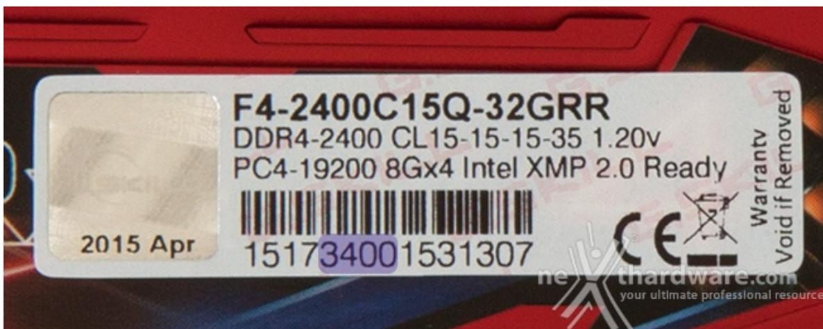
Pur non avendo disassemblato il modulo per mettere a nudo gli ICs utilizzati, possiamo affermare con ragionevole certezza che si tratti di chip di produzione SK Hynix in base alla porzione del serial number evidenziata in foto, che contraddistingue, secondo uno schema adottato dal produttore, i moduli di memoria che utilizzano questa tipologia di chip.
