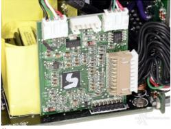
Particolare della scheda di controllo ZDPM5 (Zero Delay Power Monitoring System).
