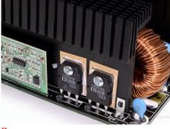
Particolare dei Mosfet facenti parte del sistema di controllo del fattore di potenza (APFC).
