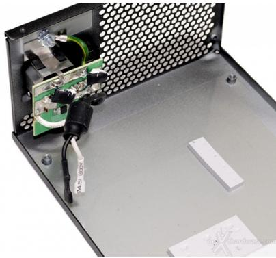
Anche sul nuovo Enermax DigiFanless 550W parte del filtro EMI d'ingresso è ricavato su un piccolo PCB ancorato al blocco presa/interruttore: tra lasciando i due condensatori collegati a terra, non abbiamo modo di verificare la presenza di altri elementi.
