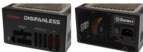
La parte frontale ospita tutte le connessioni modulari: la posizione e la geometria dei connettori, sebbene favorisca l'inserimento dei cavi, non risulta particolarmente efficace nel relativo disinserimento, soprattutto con l'alimentatore montato.
