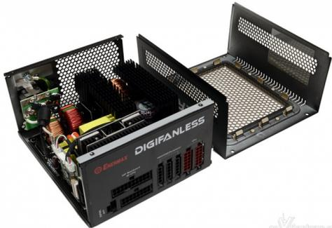
Rimosse le quattro viti che trattengono la cover superiore, abbiamo modo di separare le parti e osservare la circuiteria interna del nostro Enermax Digifanless 550W.
