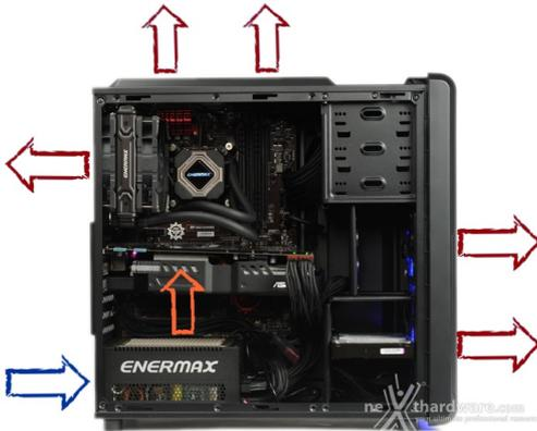
Se possiamo azzardare un ulteriore consiglio, aggiungerei che, con case non dotati di molte feritoie, è consigliabile montare tutte le ventole in espulsione in modo che l'unico punto d'immissione risulti proprio l'alimentatore che vedrà, quindi, un considerevole aumento del flusso d'aria interno.
