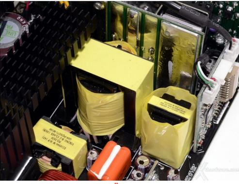
La tensione d'ingresso ad elevata frequenza può ora essere ridotta a valori compatibili con gli stadi successivi mediante un "semplice" trasformatore dalle ridotte dimensioni.
