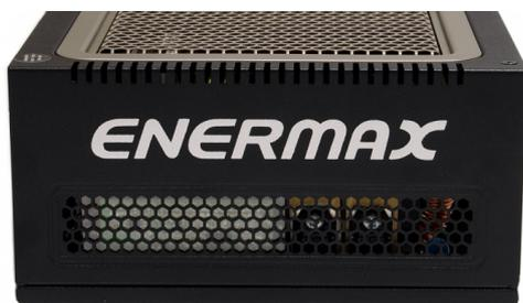
Le griglie laterali, posizionate nella parte bassa, consentono all'aria fresca di entrare all'interno per poi, una volta "scaldata" dai componenti, salire naturalmente verso l'alto attraverso l'ampia griglia superiore.
