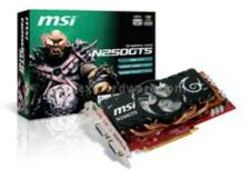
MSI N250GTS-2D1G utilizza l' unica soluzione di raffreddamento Quad Pipe, caratterizzata da 4 heat pipe, dalla spessa base di rame e da un grosso dissipatore. Lo speciale sistema di raffreddamento non solo abbassa le temperature della GPU, ma il flusso d' aria rinfresca le memorie, i MOSFET e altri componenti ed infine aiuta ad espandere le possibilità di overclock della MSI N250GTS-2D1G.
